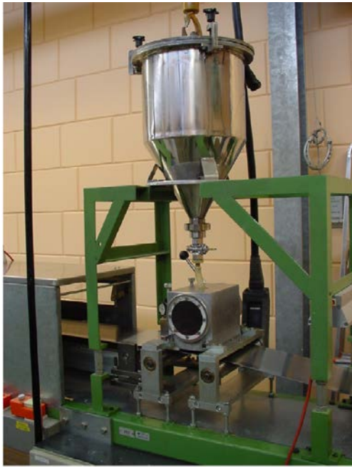
Abbildung 1: Bandanfang mit Gießwerkzeug und Vakuumbehälter Picture 1: Band beginning with casting tool and vacuum tank
