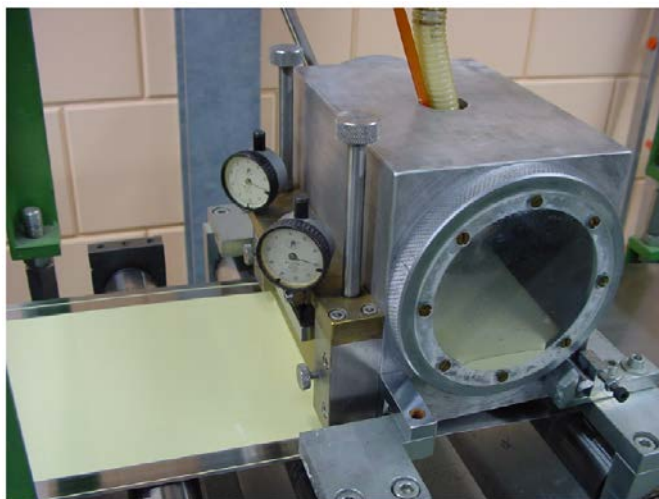
Abbildung 2: Gießwerkzeug mit Doctor Blade und Füllstandsfenster Picture 2: Casting tool with Doctor Blade and fluid level window
