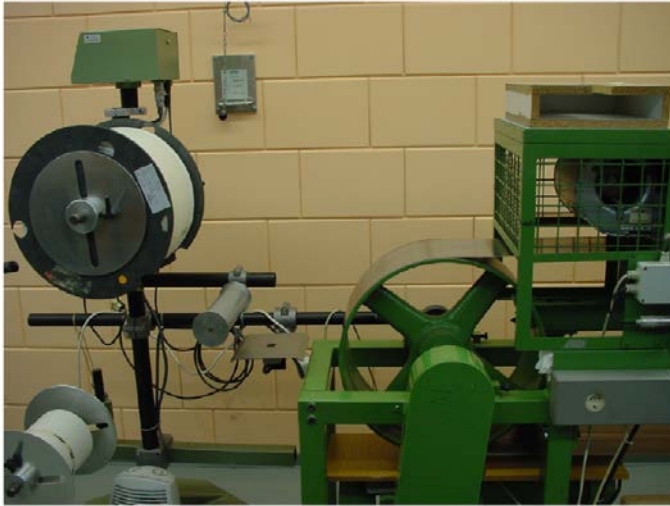
Abbildung 9: Bandende mit Bandaufrollenheit
